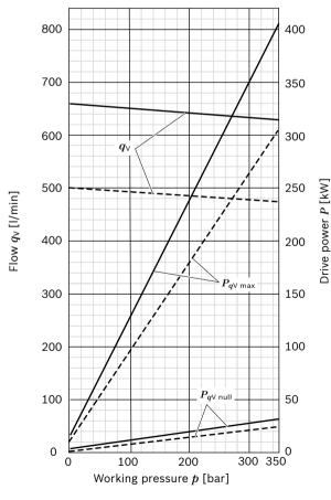
*n* = 1320 rpm - - - - *n* = 1000 rpm
