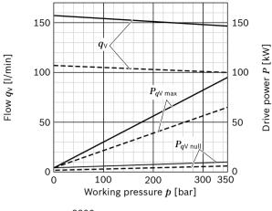
*n* = 2200 rpm - - - - *n* = 1500 rpm
